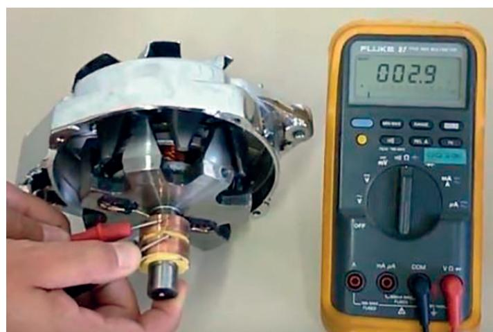
O teste de medição da resistência do rotor é muito importante para garantir a vida útil do regulador de tensão e evitar sua queima prematura.
